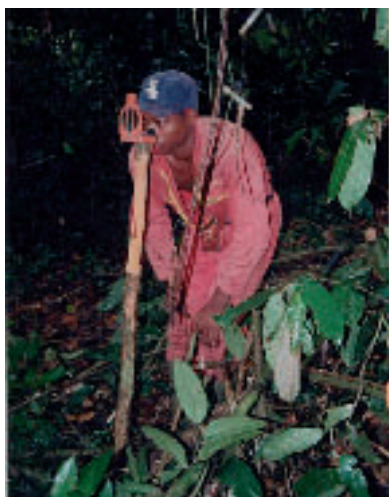
Visée à l'aide d'une boussole TOPOCHAIX pour l'ouverture d'un layon © Nicolas BAYOL
